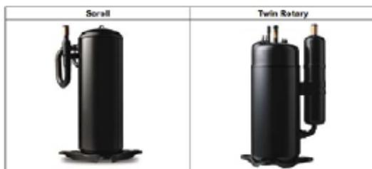
Il motore dei compressori è del tipo **sincrono a magneti permanenti**, senza spazzole, pilotati da un driver ad onda trapezoidale nel campo di velocità compreso fra i 30 (20) ed i 120 Hz Tecnologia BLDC "**Brush Less Direct Current**".
