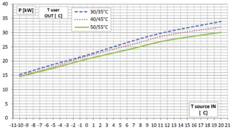
**XE 22 – Potenza assorbita in riscaldamento al variare della temperatura lato sorgente**
