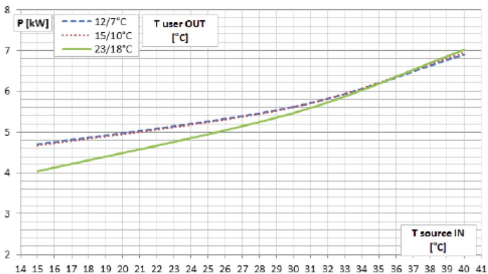
Limiti di funzionamento di XE 22-33 per acqua prodotta e temperatura lato sorgente
